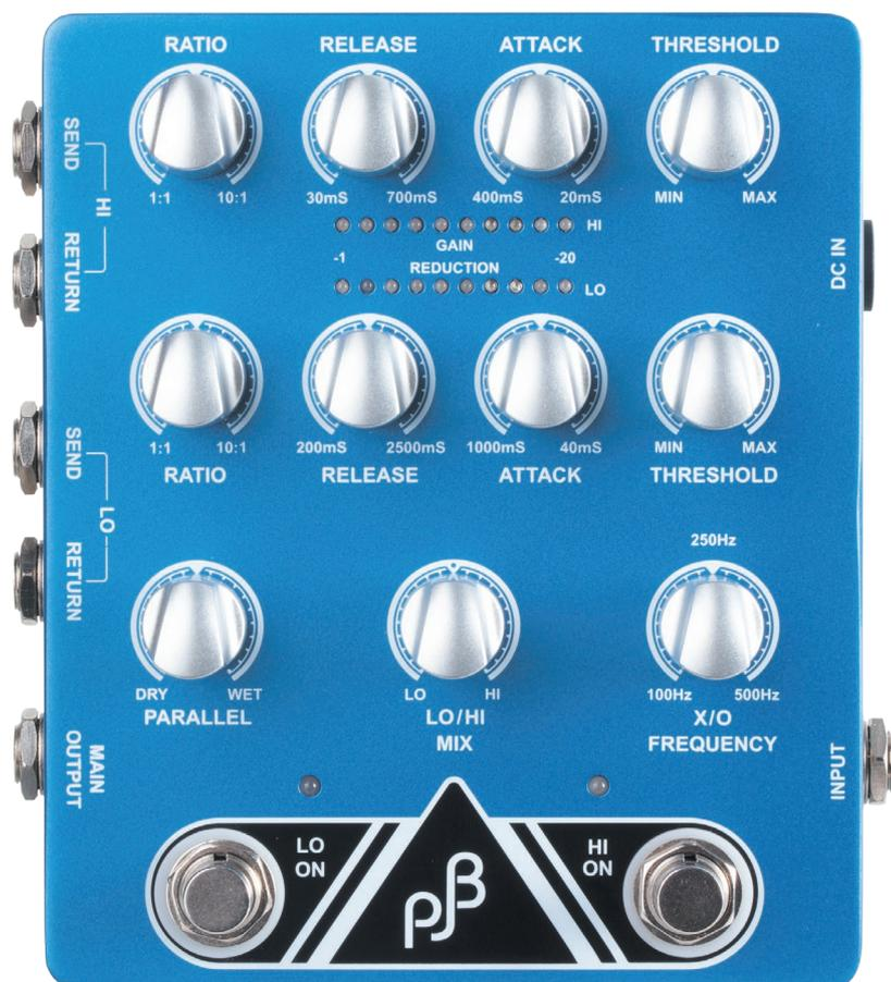
シグナルをハイとローに分け、それぞれにコンプレッサーを掛けられるペダル。コンプレッサーはスタジオ機材に匹敵する音質とコントロール性能を備えたプロ仕様。また各帯域ごとにループを備えており、ペダルで失われがちな低音のパワーはそのままに、ハイだけにドライブやフィルターを掛けたり、過度な低音の膨らみを抑えて音程と音質を明瞭にするなど、アイデア次第で様々な使い方ができます。
