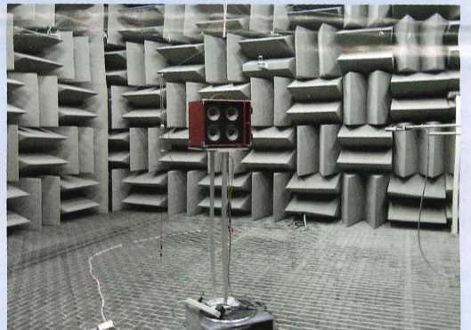
巨大な無反響室にセットされているのは最新スピーカー C4。
