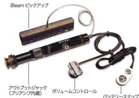
(注) 上記は iBeam Active です。iBeam Passive には、ボリュームコントロールとバッテリースナップはありません。
