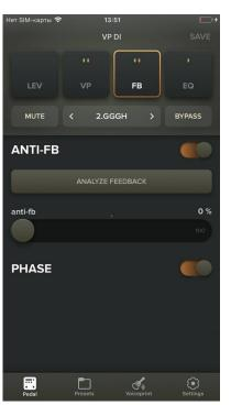
ANTI-FB: アンチフィードバック On/Off ANALAYZE FEEDBACK: FBポイントを測定
